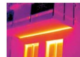
La falta de aislamiento del alféizar de la ventana lleva a una pérdida de energía. El resto de la zona de la fachada está suficientemente aislada.
