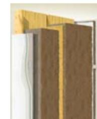
Montante doble ventilado: perfil de madera
