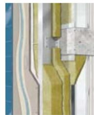
Montante doble con perfiles exteriores continuos
